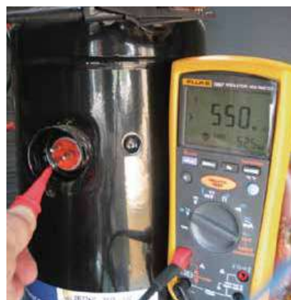
Imagem 12 e 13: Medição em compressor scroll hermético com CA.
