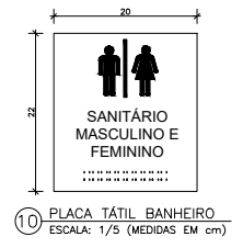
10 PLACA TÁTIL BANHEIRO ESCALA: 1/5 (MEDIDAS EM cm)
